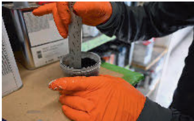
Hoch reaktiv: Erst werden Füller und Verdünner vermischt, dann kommt der Härter dazu. Ab diesem Zeitpunkt sollte zügig appliziert werden.
